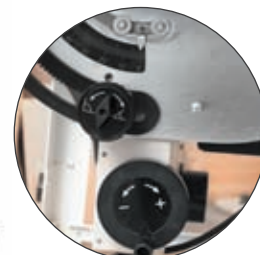
Plynulé naklonenie kotúča
