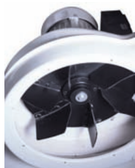
Špeciálne konštruované dýchadlo pre vysoký výkon
