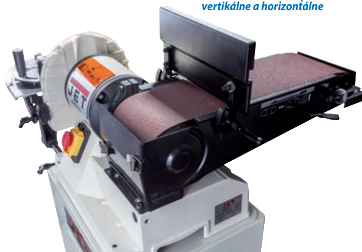
Pásová brúska naklopiteľná vertikálne a horizontálne
