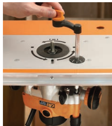
Nastaviteľná výška frézovania vo frézovacom stolíku
