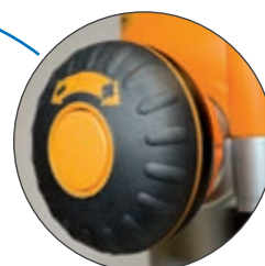
Prepínanie medzi voľnou a pevnou polohou zdvíhu frézy
