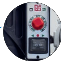
Plynule meniteľná rýchlosť 2 až 12 m/min a navyše so spätným chodom
