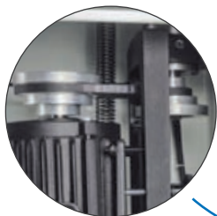
Zmena otáčok pomocou remenice
