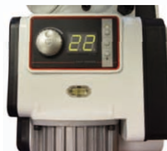
Nastavenie a zobrazenie rýchlosti podávania
