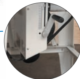
Plynulé nastavenie výšky rezu
